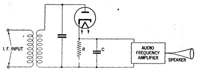
FIG. 21-Diode detector circuit.
