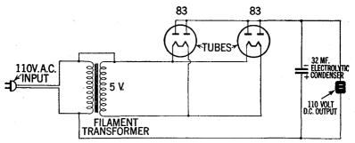
FIG. 16—A simple 110 volt-a.c./110 volt-d.c. rectifier unit.
